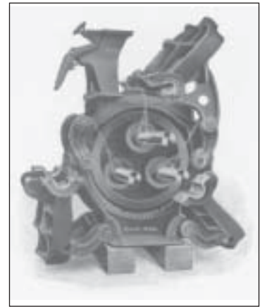
2 Die Maxecon Mühle (hier dargestellt), der Nachfolger der Kent Mühle 2 The Maxecon mill (illustrated here), the successor of the Kent mill
