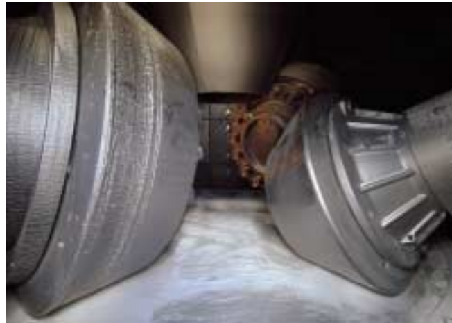
9 M-Walze nach Aufschweißung (links), S-Walze (rechts) 9 M-rollers after rewelding (left), S-rollers (right)
