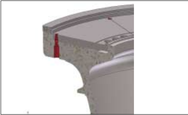
2 Schnitt Mahlschüssel/Austragsbohrung 2 Sectional view of grinding table/discharge hole
